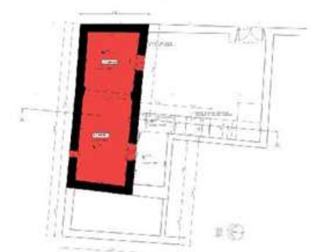
Παράδειγμα διώροφου μονόχωρου μακριναριού σπιτιού. Κάτοψη ισογείου (πηγή: από σχέδιο Γ. Γιαξόγλου)
